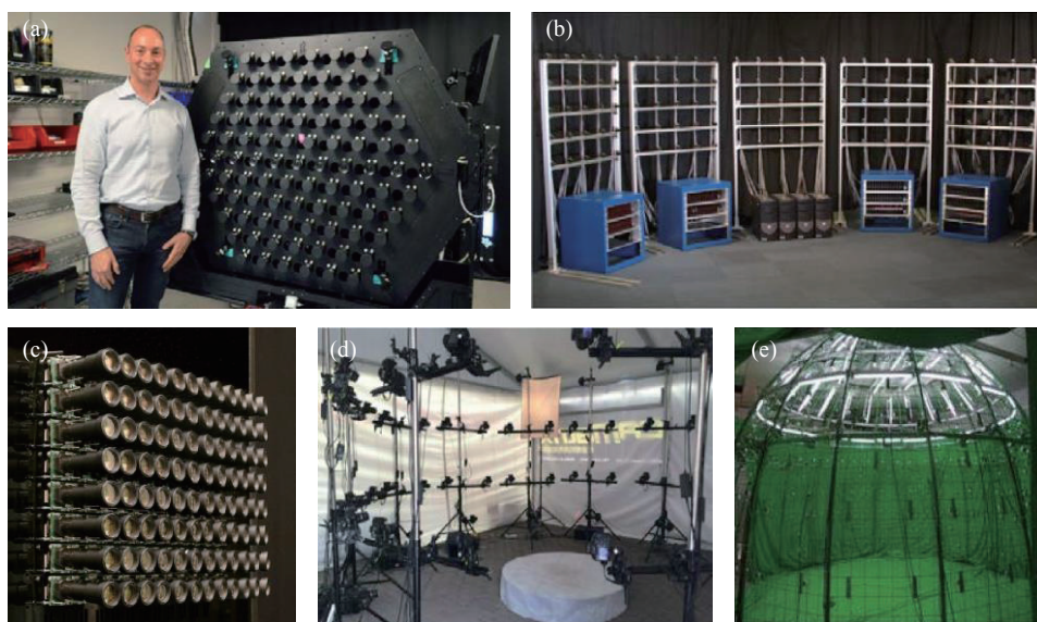
图 41 多相机拼接系统。(a) Lytro 公司所研制的光场采集系统 Immerge; (b) 斯坦福半环型相机阵列系统; (c) 斯坦福平面型相机阵列系统; (d) CAMatrix 环型相机阵列系统; (e) 清华大学鸟笼相机阵列系统
