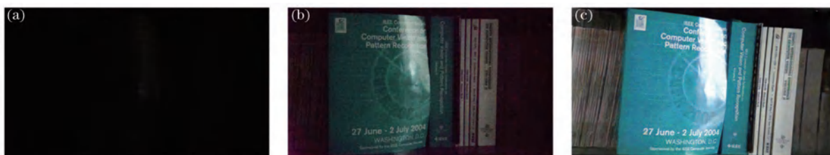
图 14 基于深度学习进行极弱光成像的结果 [34] 。(a)摄像机输出(ISO 8000);(b)摄像机输出(ISO 409600);(c)由原始数据(a)恢复得到的结果
