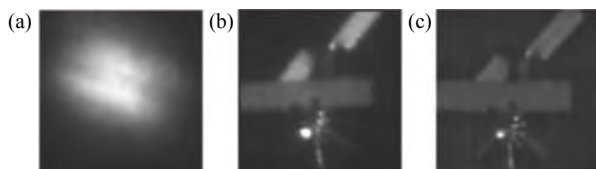
图 177 SOR 望远镜对低轨卫星的成像效果 [875] 。(a) 校正前; (b) 校正后; (c) 校正+图像处理
